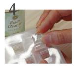
硬化したレジンと型との間に レジンクリーナーを染み込ま せ、全体に馴染んだら取り出 します。
