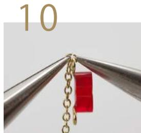
10 Cカンを平ヤットコで前後に動かして開き、クランクヒートンとネックレスチェーンをつなげます。
