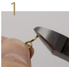
1 クランクヒートン (ゴールド) の先端をニッパーで1.5mmほどカットします。
