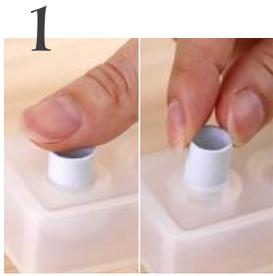
1 モールドの口にパイプを押し込み、軽く引っ張って口を戻します。
