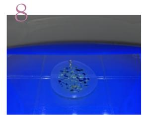
UV-LED ライトで両面 2 分ずつ照射してしっかりと硬化させます。
